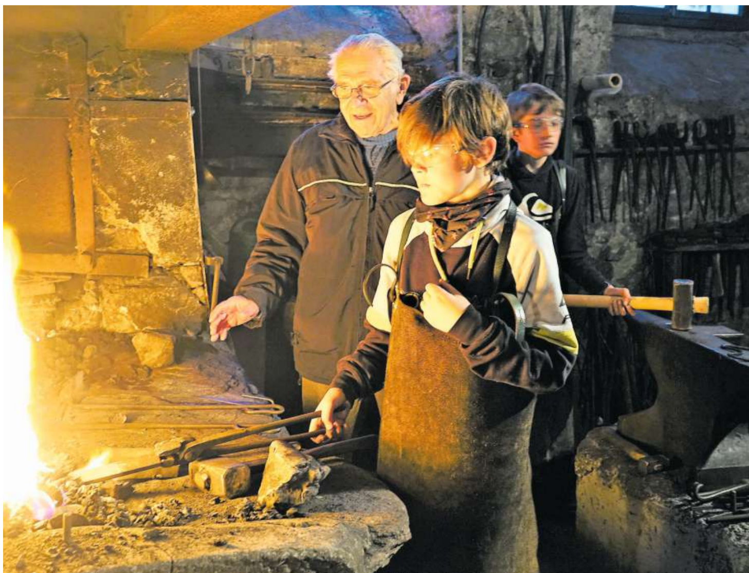
Ernst Meier beobachtet einen Schüler beim Erhitzen des Metalls in der Esse der Hammerschmitte Gehler.
