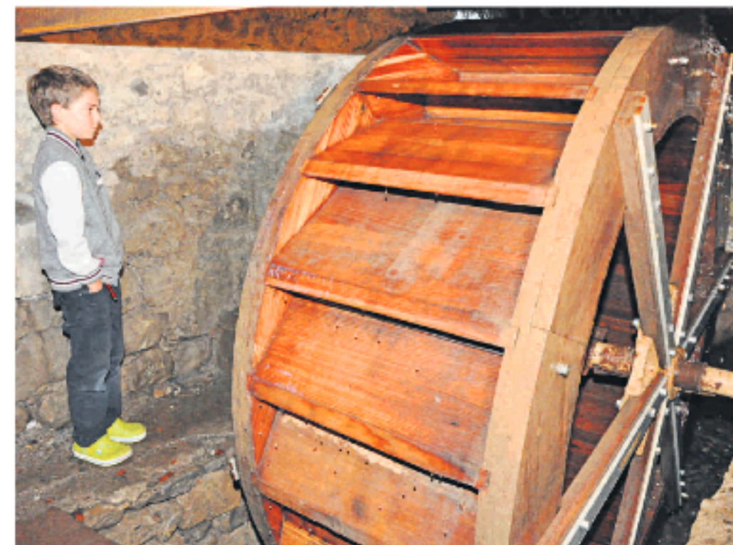
Alte Technik I: Der zwölfjährige Michael Zogg interessiert sich für das neue Wasserrad in der Werkzeugschmiede im Gehlerhaus, das den grossen Schleifstein antreibt.
