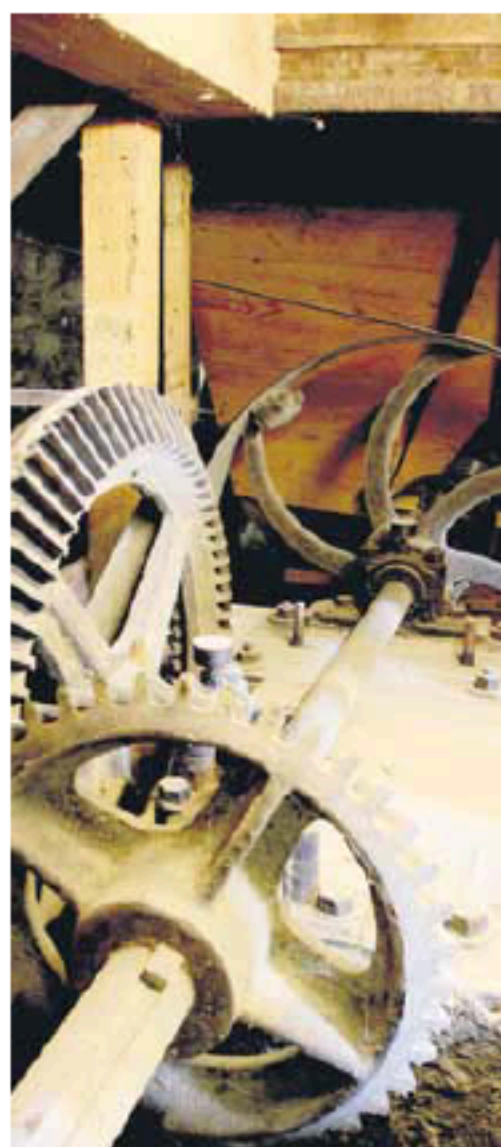
Links: Unter dem Fussboden ist gut zu erkennen, wie die Energie des einzigen Mühlrades verteilt wird. Rechts: Werner Hungerbühler kennt die Maismühle so gut wie kein zweiter. (Fotos: Doris Lippuner/Simone Wald)
