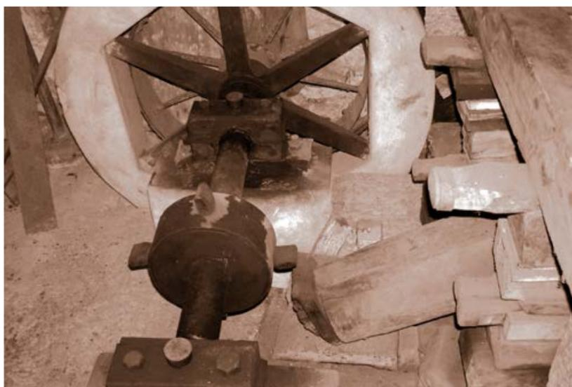
Welle mit Nocken- und Schwungrad in Hammerschmiede
