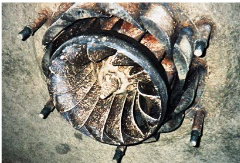
Leitwerk und Wasserrad mit Kalkablagerung
