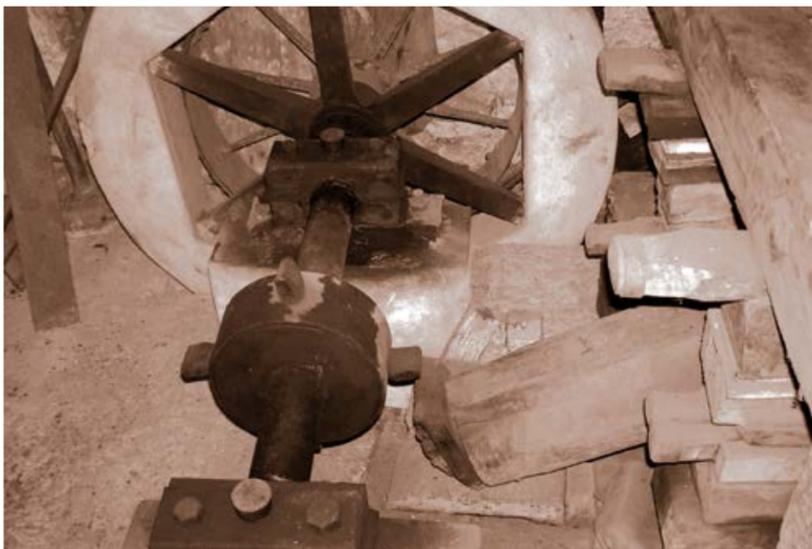
Welle mit Nocken- und Schwungrad in Hammerschmiede
