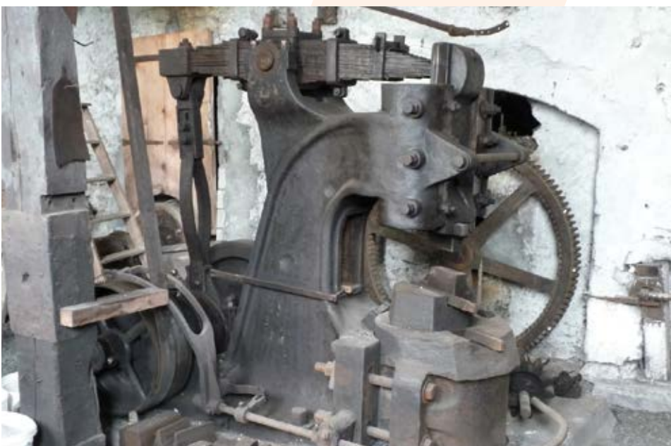
Federhammer mit Kammrad
