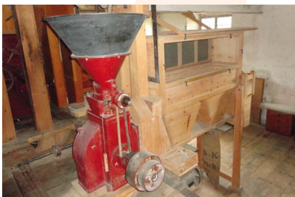
«Soder-Mühle» mit Sortier- und Abfüllanlage
