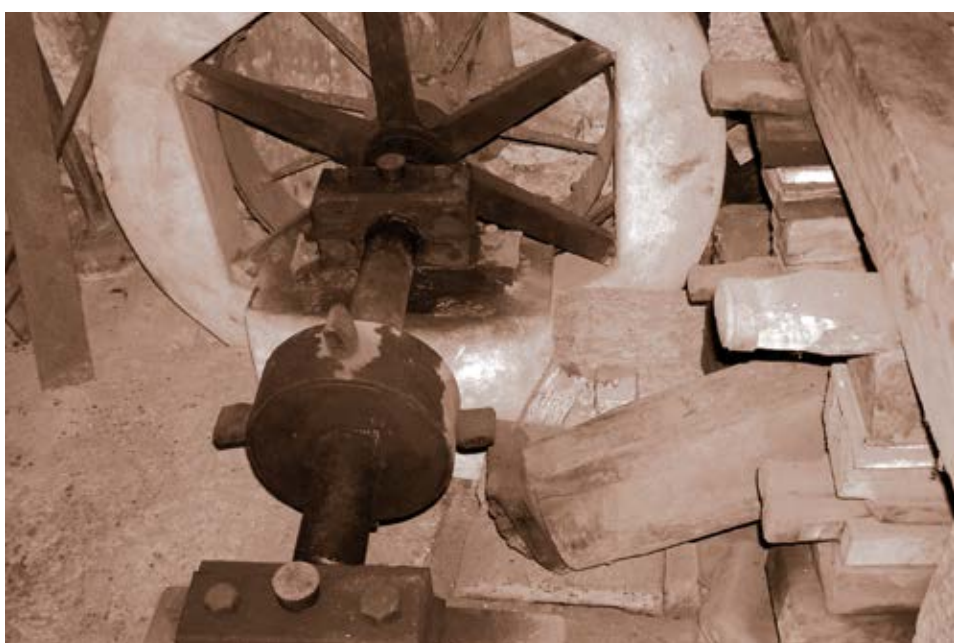
Welle mit Nocken- und Schwungrad in Hammerschmiede
