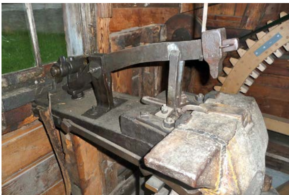
Dengelhammer (Konstruktion Caspar Roth)
