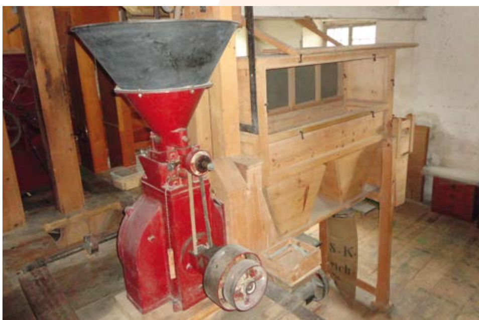
«Soder-Mühle» mit Sortier- und Abfüllanlage
