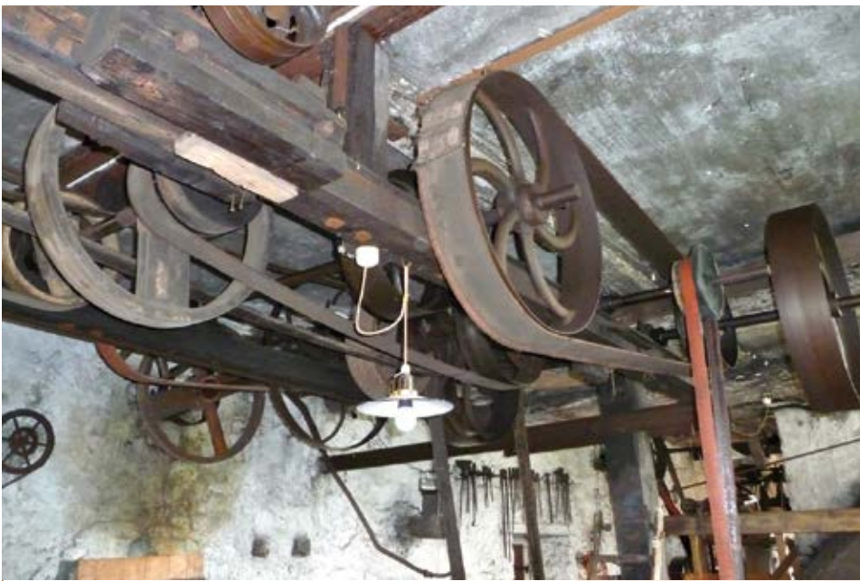
Über die Transmission werden Hämmer, Bohrmaschine und Gebläse angetrieben.
