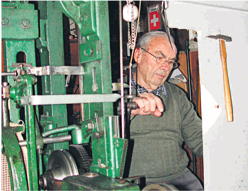
Sicherer Blick: Die Hand von Kaspar Vetsch sel. an der Stickmaschine und die Vorlage am Pantographen im Auge. Bilder Paul Schawalder
